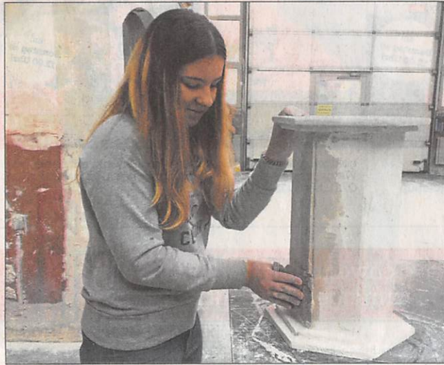
Säulen aus Gipskarton entstehen in Handarbeit. Foto: Schule
